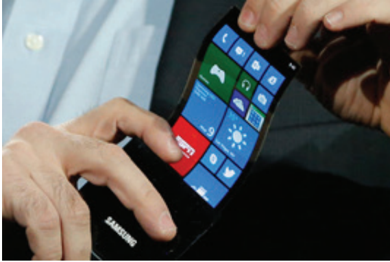
Resim 8.5 Bükülebilir OLED ekran.
