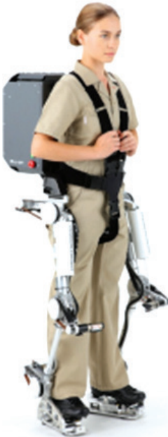
Resim 8.4 Güçlendirilmiş dış iskelet örneği.
